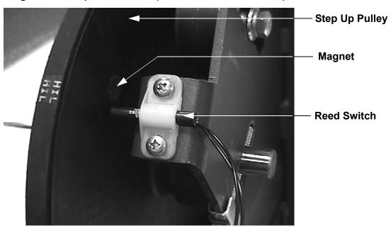
Diagram 6.4 - Speed Sensor (serial code A998)
